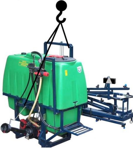
Рис. 15.1 Схема строповки опрыскивателя.
