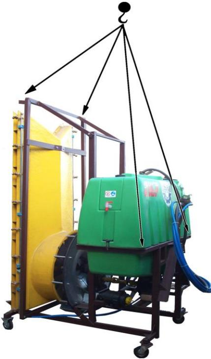
Рис. 15.1. Схема строповки опрыскивателя.
