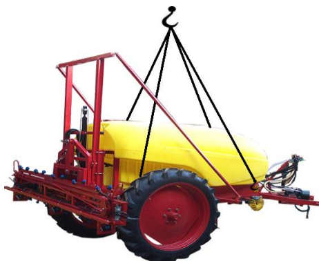
Рис. 15.1 Схема строповки опрыскивателя.
